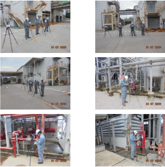
ภาพที่ 1 แสดงการตรวจวัดระดับเสียงเพื่อจัดทำแผนผังแสดงระดับเสียง (Noise Contour Map)
